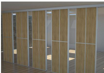
División Acústica Móvil modular conformada por Paneles Acústicos Arquitectónicos Móviles Auto Portante, suspendidos de una estructura superior anclada al techo de la edificación. Cada panel permite acoplar con uno similar por los extremos izquierdo y derecho, ofreciendo un sello acústico. Están fabricados en estructura metálica (aluminio + acero), poseen mecanismo para sello acústico inferior y superior además de acabado por ambas caras.
