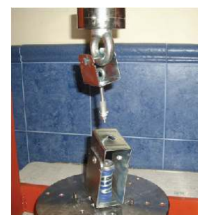
Detalle de la muestra bajo carga 200 Kg. Rompe por la zona superior
